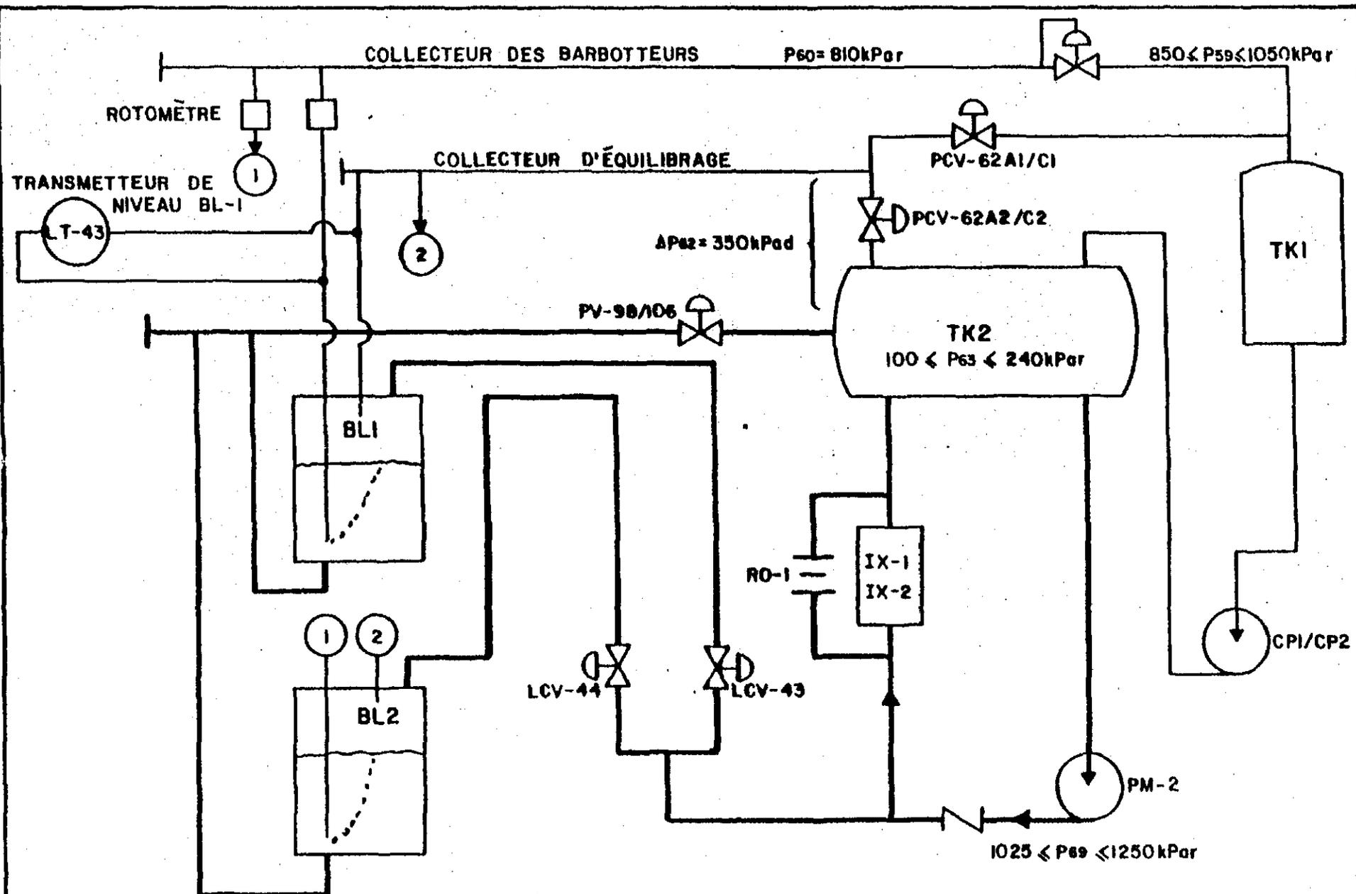
FIGURE 2A/ Schéma simplifié du système des barres liquides.
